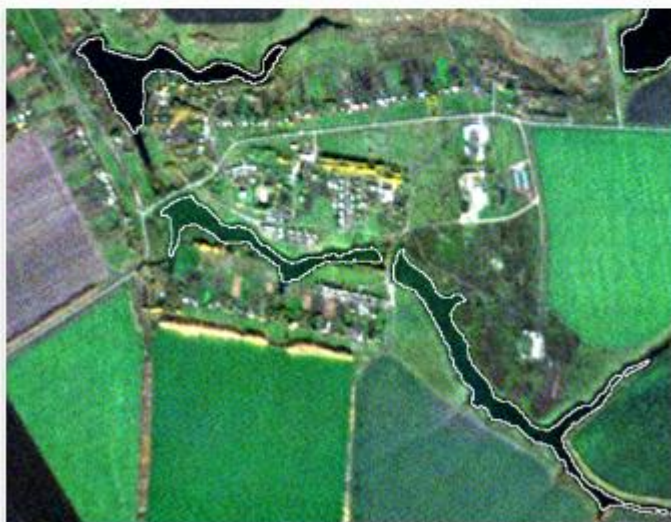
Результат векторизации автоматически выделенных водных объектов, наложенный на исходный космический снимок
